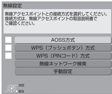
無線ブロードバンドルーター(アクセスポイント)がAOSS™に対応している場合は、「AOSS方式」を選ぶと、簡単に設定することができます。AOSSに対応していない場合、WPS 対応機器では「WPS(プッシュボタン)方式」を、それ以外では「無線ネットワーク検索」を選び、設定してください。
