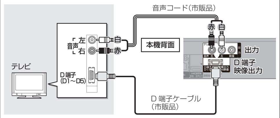
AACS(ブルーレイディスクの著作権保護技術)の運用ルールの制限により、本機を含む2011年1月以降に生産開始した機種では、D端子からハイビジョン映像で出力されない場合があります。(→2011)
