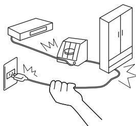
芯線の露出、ショート、断線により火災・感電の原因となります。
