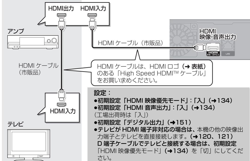
本機をビエラリンク(HDMI)に対応した当社製テレビとアンプにHDMIで接続すると、本機の音声出力先を切り換えることができます。(→19)
