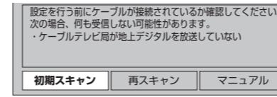
②□を押し、方式切換の画面が表示されたら◀▶でチャンネルスキャン方式を選び、**(決定)** を押す
